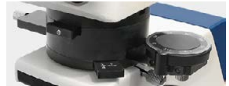
Bertrand-Linse, \lambda Slip, 360° rotierbarer Analysator (herausnehmbar)
